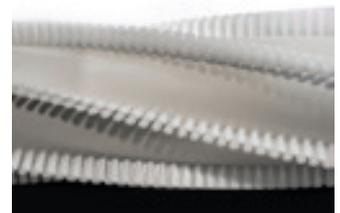
Die speziell angefertigte Bürste sorgt für den optimalen Polier- und Bürsteffekt ohne das Getreidekorn zu verletzen.
