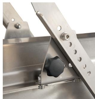
Regulierbarer Reinigungsgrad durch verstellbaren Arbeitswinkel.
