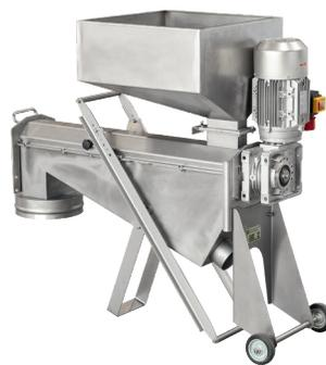
Der vom Getreidekorn abgebürstete Staubanteil wird hygienisch über eine kompakte Absauganlage mit Luftfilter in einen Foliensack abgesaugt.
