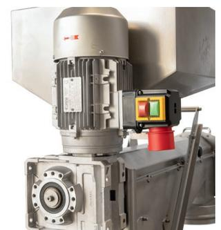
Ein starker Industriemotor mit aufgebautem Motorschutzschalter treibt die Maschine an.
