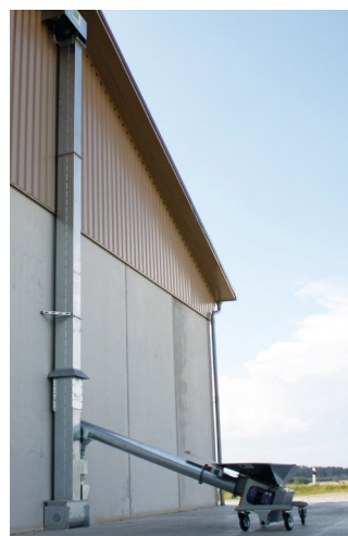
Kettenelevators mit Getreidekanone
