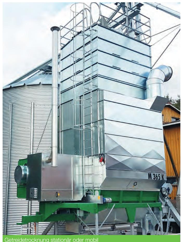
Getreidetrocknung stationär oder mobil
